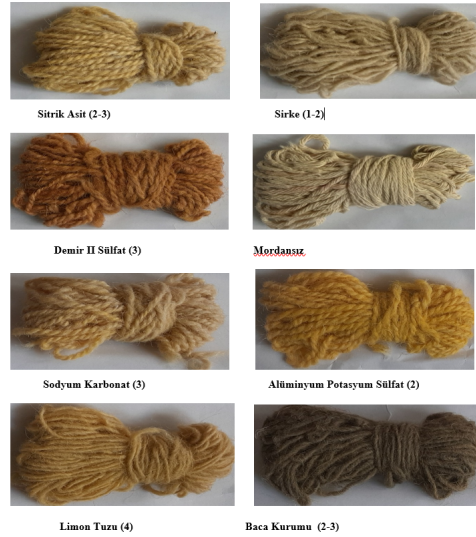
Resim 9. Su Damlası (ıslak-kuru) Haslığı Deney Numuneleri (Hülya Kaynar, 2016)
