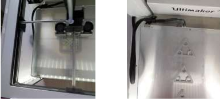
Görsel 18. Paraların 3B yazıcıda yazdırılması
