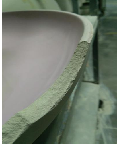
Resim 2. FFC çamuru pürüzlü yüzey görüntüsü
