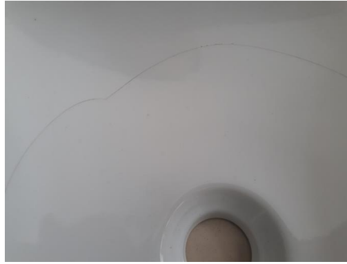
Resim 9. Nihai üründe çatlak görüntüsü
