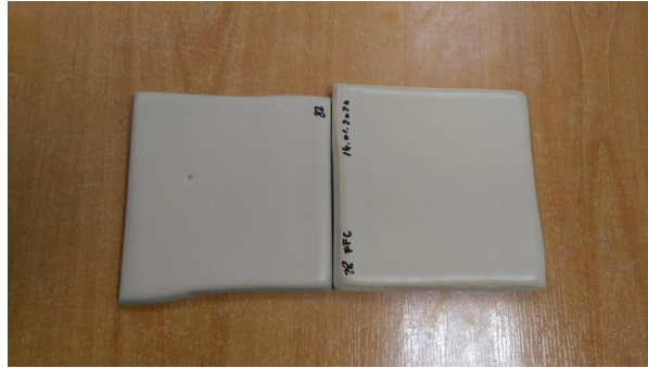
Resim 8. a) Vitreous-chine çamuru sırlı, b) FFC Çamuru sırlı görüntüsü
