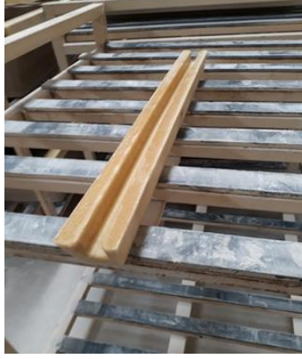
Resim 6. Destek ve doğrultma aparatı iç görüntüsü
