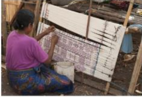
Resim 14. Çerçeve üzerinde ikat deseninin parmak ölçüsüyle yerleştirilmesi (Buckley, 2014: 88).
