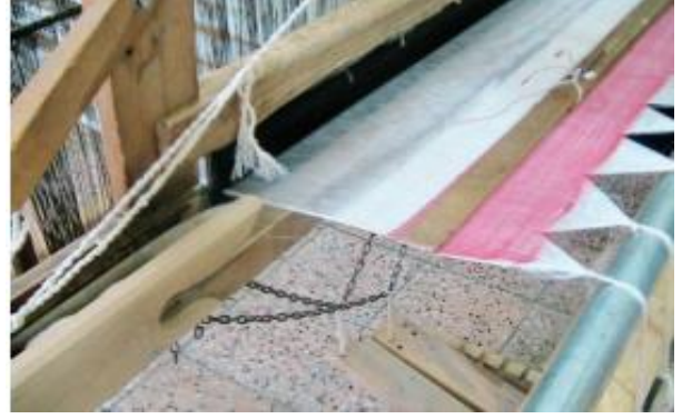
Resim 5.B Kamçı mekanizması (Başaran, 2018: 16).
