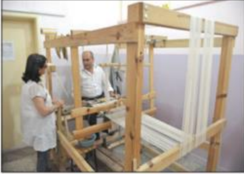
Resim 5. A Kamçılı tezgâh örneği (Yanar ve Akpınarlı; 2016: 176).
