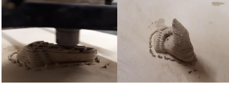
Görsel 7.Yazdırma işlemi (1), Yazdırma işlemi bitmiş seramik yaş bünye (2)
