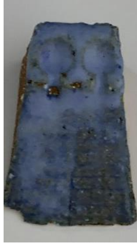
Görsel:12. Sır Reçetesi 9'a ait açık mavi opak-parlak sır,(1225°C)
