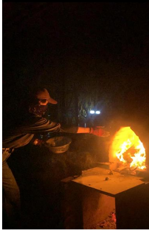
Görsel 3. Sodanın organik madde katkısı (talaş) ile fırına verilmesi, Dilek Kocakaplan Arşivinden
