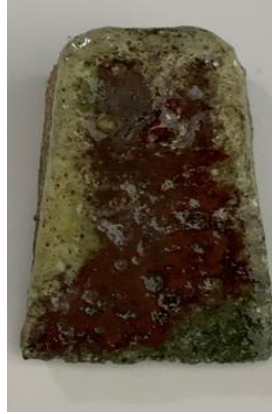
Görsel:7.Sır Reçetesi 4'e ait al ve ak sır karışık parlak sır, (1225°C)
