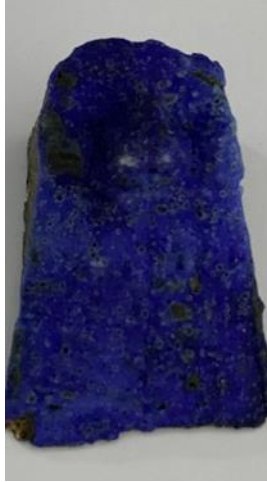
Görsel:13. Sır Reçetesi 10'a ait patlıcan moru mat sır, (1225°C)
