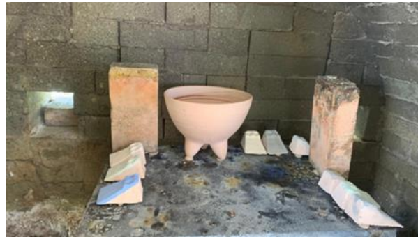
Görsel 2. Soda Fırınına sır deneme tabletlerin yerleşimi, Dilek Kocakaplan Arşivinden
