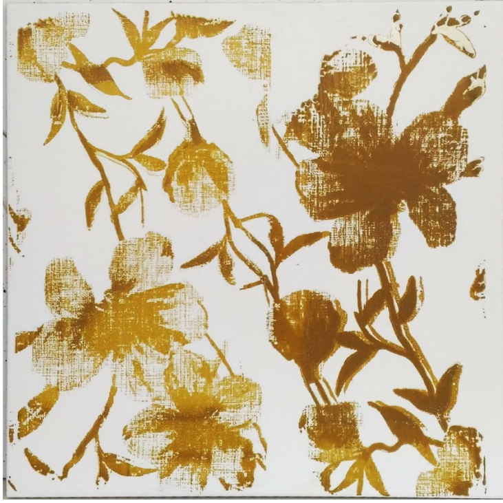
Şekil 12. Salbaş Kili Boyar Maddesinin 1192°C Serigrafi Baskı Tekniğiyle Çiçek Deseni Uygulama Çalışması
