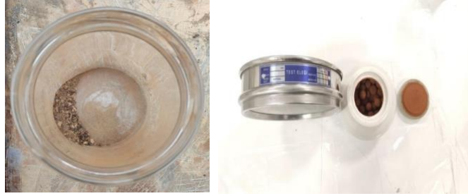
Resim-3: (A) Pigmentler ve (B) Toz pigmentleri değirmende kuru çevirme işlemi ardından 125 mikron elekten geçirme işlemi, (Cihan, Kubat, s.43, 2024)
