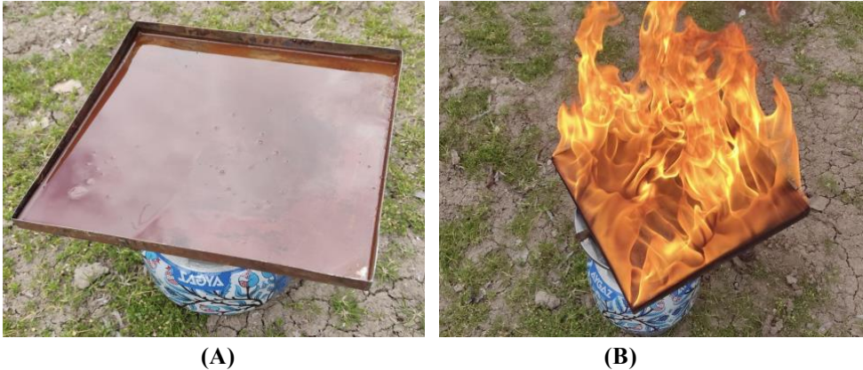
Resim-1: (A) Mavi atık boyanın çelik tepside ısı işlemine tabi tutulması, (B) Isı verilen solvent bazlı dijital boyanın alev alması, (Cihan, Kubat, s.42, 2024)
