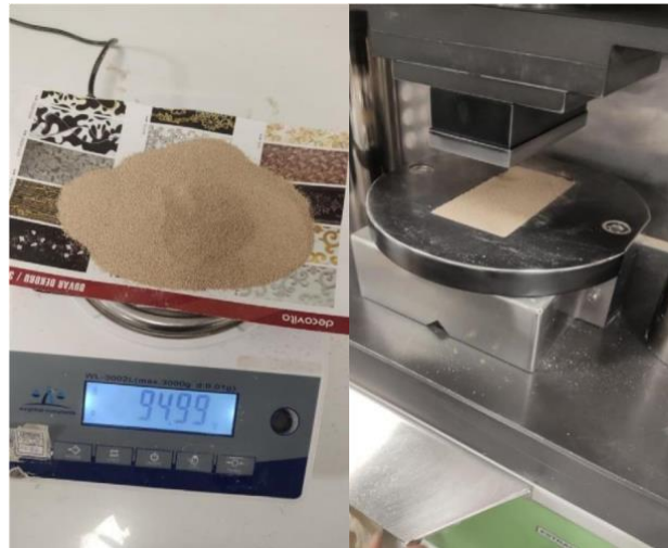
Resim-4: Pigmentlerin uygulama yapılacağı deneme tabletlerinin granül ölçüm işlemi ve preslenmesi, (Cihan, Kubat, s.44, 2024)
