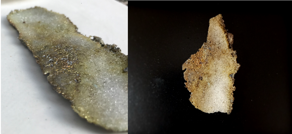
Görsel 9. Alevde alazlama işlemi sonucu cam yüzeyinde ortaya çıkan renk değişimleri (Kaynak: Yazarın kişisel arşivi)
