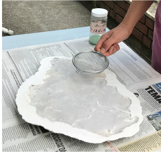
Görsel 7. Cam granüllerin refrakter kalıp içerisine elenmesi işlemi (Kaynak: Yazarın kişisel arşivi)
